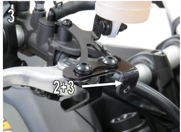
6. Montieren Sie die Handprotektoren mit den Lenkerendeneinsätzen und ziehen Sie die Inbusschraube M8 x 45 (8) fest. Befestigen Sie die Handprotektoren mit den M6 x 20 Schrauben (4) und M6 Muttern (5) an den Halterungen *Abb.4 / Fit hand guards using bar end inserts and tighten M8 x 45 cap socket screw (8). Fit the hand guards to the brackets using the M6 x 20 screws (4) and M6 Flange nuts (5) Fig.4*
