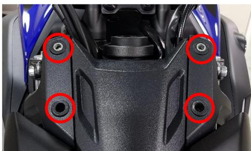
2. Befestigen Sie hierauf nun den Aluminium-Halter mittels den M6 x 20mm Schrauben an den oberen Bohrungen den M6 x 35mm Schrauben an den unteren Bohrungen und setzen Sie die Gummihülsen mit Innengewinde in die 4 äußeren Löcher des Halters.
