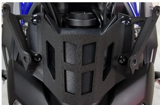
3. Montieren Sie nun die Scheinwerferverkleidung mittels den Schrauben M5 x 25mm und U-Scheiben am Halter
