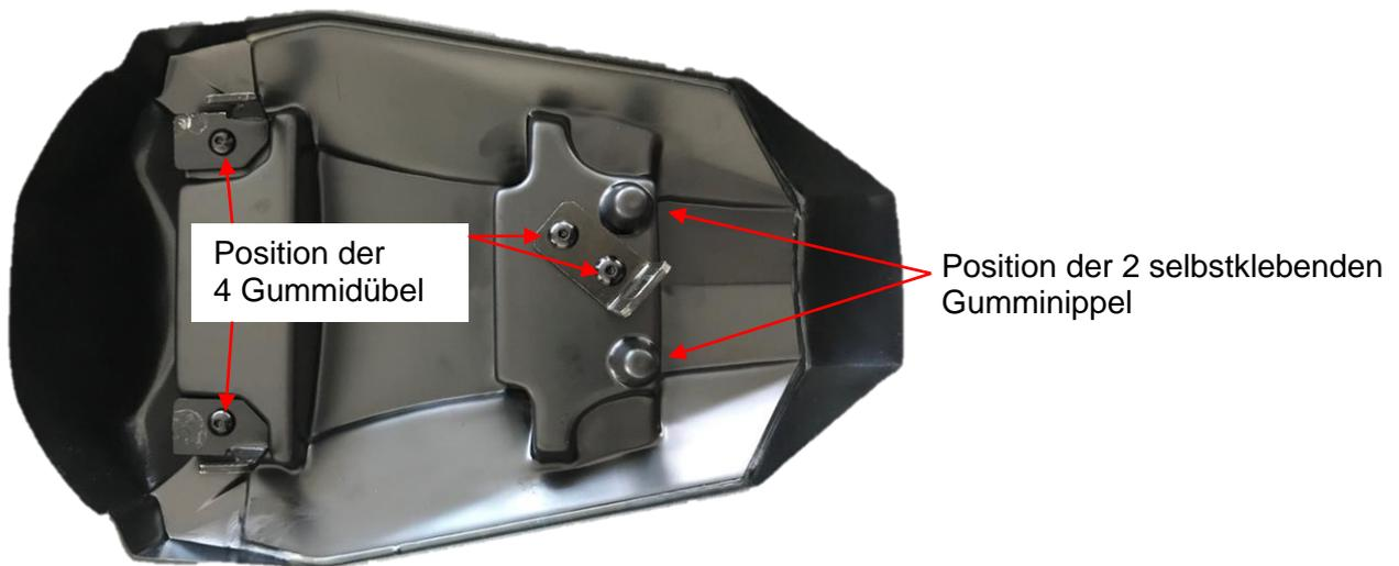
Bei Bedarf kann zwischen Sitzkeil und Originalverkleidung, selbstklebende Schutzfolie angebracht werden, um evtl. Kratzer durch Scheuern an der Original-Verkleidung zu vermeiden.
