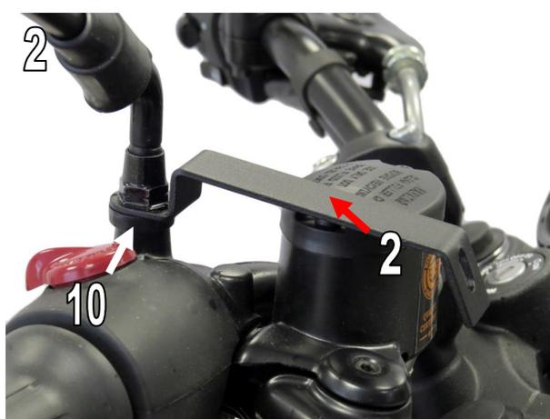
Entfernen Sie die OEM-Lenkerendschraube und montieren Sie die Handschützer mit den unten in Abb. 3 gezeigten Teilen an den Lenkerenden. / Remove OEM bar end screw and fit hand guards to bar ends using fittings as shown below in Fig.3
