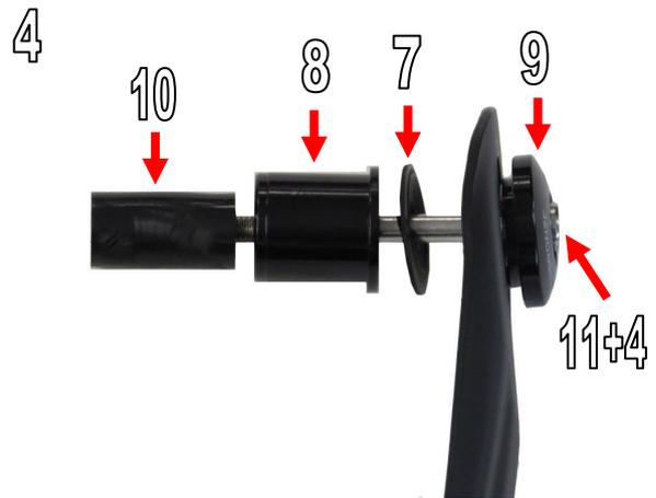
6. Montieren Sie die Handprotektoren mit den Lenkerendeneinsätzen und ziehen Sie die Inbusschraube M6x70 (11) fest. Befestigen Sie die Handprotektoren mit den M6 x 20 Schrauben (5) und M6 Muttern (3) an den Halterungen Abb.5 / Fit hand guards using bar end inserts and tighten M6x70 cap socket screw (11). Fit the hand guards to the brackets using the M6 x 20 screws (5) and M6 Flange nuts (3) Fig.5
