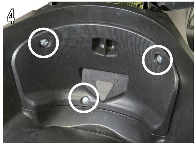
7. Entfernen Sie alle in Abb. 5 – Abb. 12 angegebenen Befestigungen, um die Platte unter dem Sitz entfernen zu können. / Remove all fixings indicated in Fig 5 – Fig 12 to allow removal of panel below seat.
