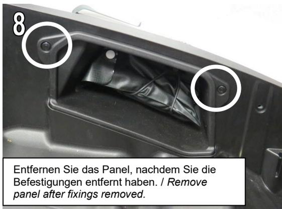
Entfernen Sie das Panel, nachdem Sie die Befestigungen entfernt haben. / Remove panel after fixings removed.
