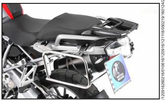
Kofferträger Edelstahl, festverschraubt mit Xplorer Koffern Side carrier, Stainless steal firmly bolted with Xplorer side cover
