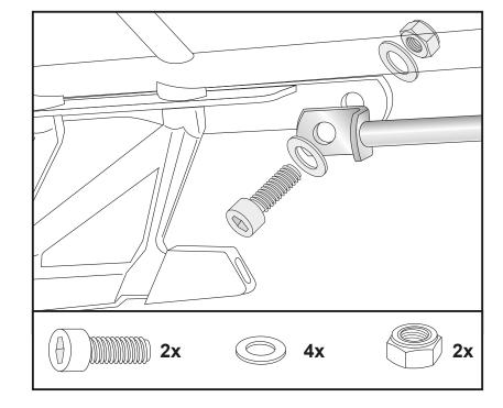
Befestigung des Verbindungsbügels: Er verläuft in Fahrtrichtung gesehen hinter dem Kotflügel.Die Verschraubung erfolgt mit den Sechskantschrauben M6x16 sowie U-Scheiben Ø6.4.
