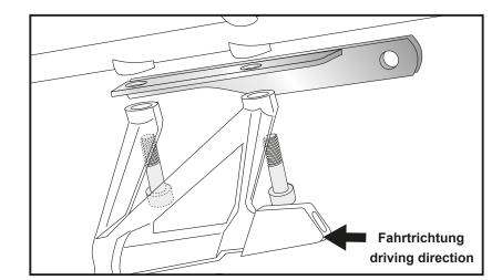
Befestigung Halteadapter vorne rechts: Auspufftopf demontieren. Soziusfußrastenhalter demontieren. Der Halteadapter wird zwischen Rahmen und Soziusfußrastenhalter mit den Original-Schrauben befestigt. Schrauben noch nicht ganz festziehen.
