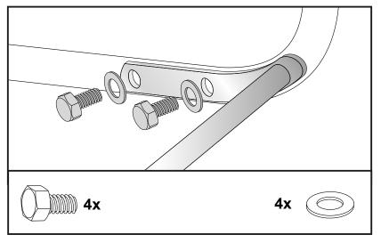
Kofferträger Edelstahl, festverschraubt mit Xplorer Koffern Side carrier, Stainless steal firmly bolted with Xplorer side cover
