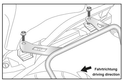
Kofferträger Edelstahl, festverschraubt mit Xplorer Koffern Side carrier, Stainless steal firmly bolted with Xplorer side cover
