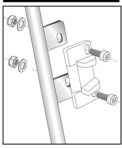
Montage des Metalladapters zum Einhaken des Kofferhalteschlosses
