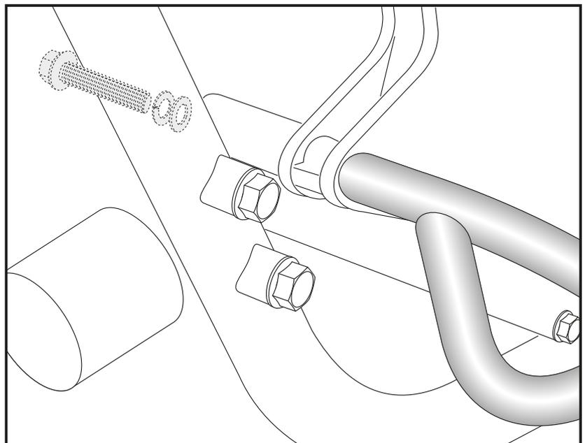
**2** Montage des Motorschutzbügels unten rechts und links:
