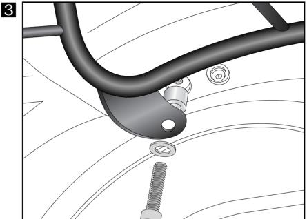
Bei zusätzlicher Montage eines C-Bow Halters werden diese außen auf den Laschen der Sissybar mitverschraubt. Hierzu die Schrauben des C-Bowhalters verwenden.
