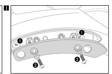
Befestigung vorne links und rechts: mit der Zylinderschraube M10x1,25x60 sowie U-Scheiben ø10,5.
