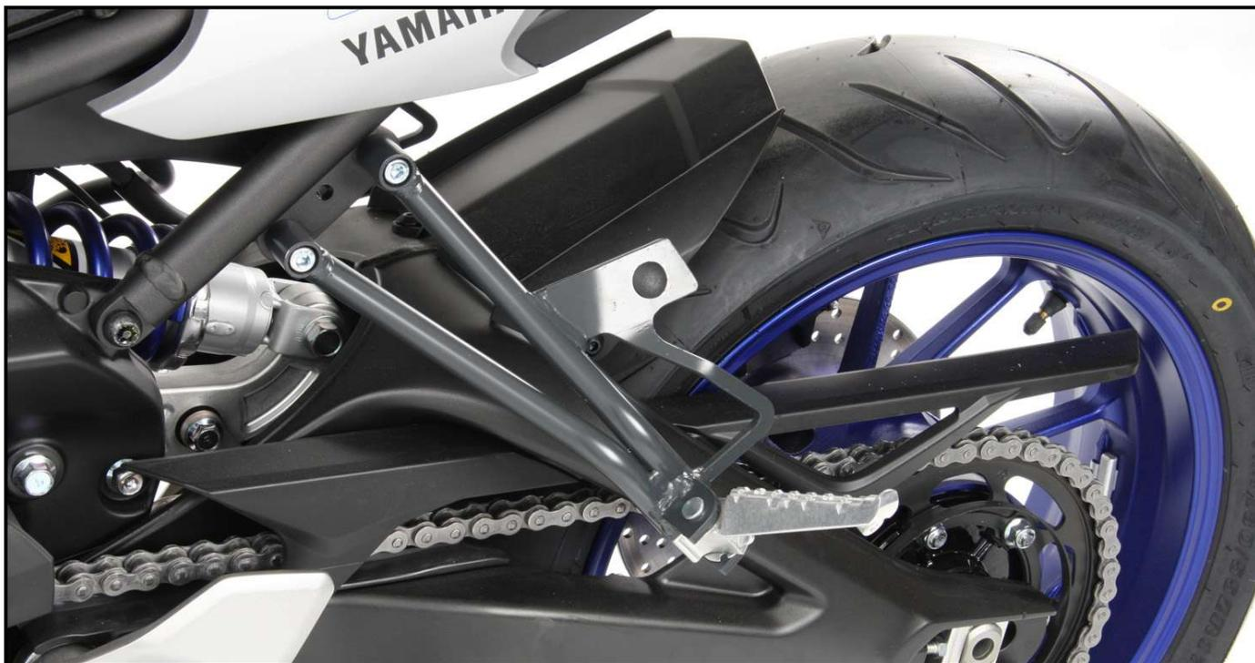
Mit der Tieferlegung sind die Fußrasten ca. 50 mm tiefer.
