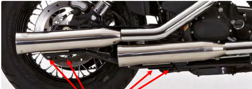
Verschraubungen des Endschalldämpfers am Original-Halter
