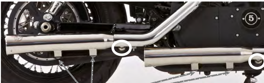
Verschraubungen des Endschalldämpfers am Original-Halter
