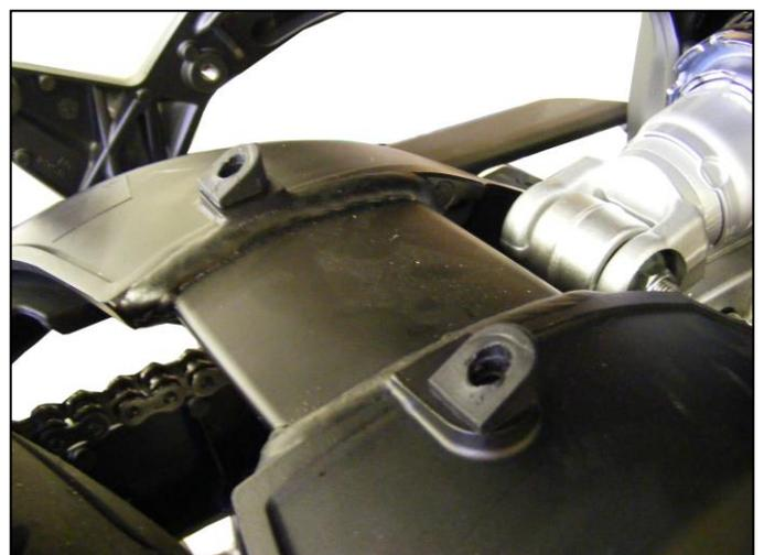
5. Ziehen Sie den Kantenschutz auf die Unterkante der Hinterradabdeckung
