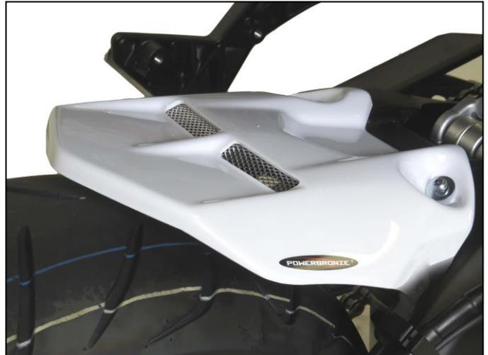
7. Befestigen Sie die seitliche Aufnahme mittels der M6x20 Schraube.
