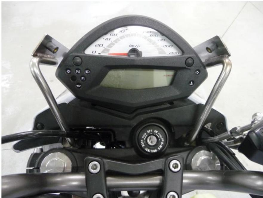
1. Montieren Sie die Halter an den oberen, vorderen Aufnahmepunkten des Cockpits (siehe Bild) und setzen Sie die „Gummidistanzen mit Gewinde“ ein.
