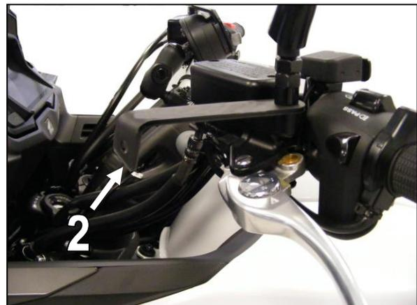
3. Montieren Sie nun den Halter in Fahrtrichtung rechts (3) ebenfalls wie in Schritt zwei an der Aufnahme des rechten Spiegels.
