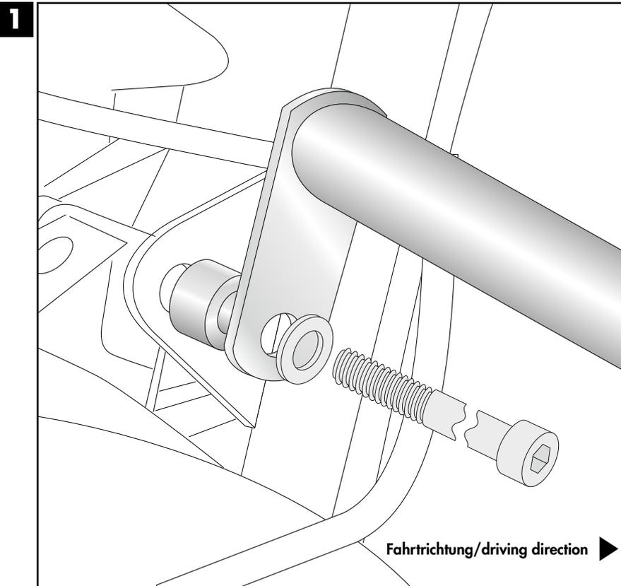
**Montage Motorschutzbügel rechts unten:**
