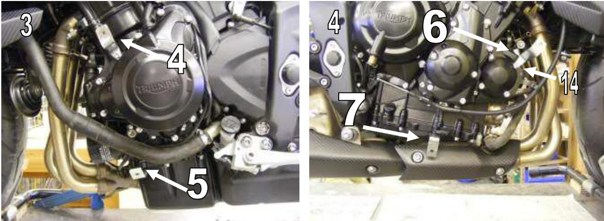
7. Befestigen Sie den linken unteren Halter (5) am Fahrzeug unter der Verwendung der M6x20 Schraube (11) und Mutter (10), ziehen Sie diese aber noch nicht fest Abb.5 / *Loosely fit the left hand bottom bracket (5) to the bike using the M6x20 screw (11) an nut (10). Fig.5*
