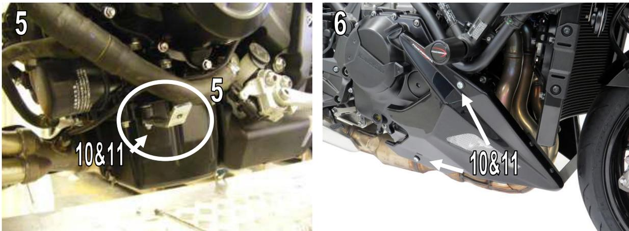
**WICHTIG: Überprüfen Sie regelmäßig die Ausrichtung des Bugspoilers und die Spannung der Befestigungsschrauben. / IMPORTANT: Always check alignment of the belly pan and mounting bolt tension periodically.**
